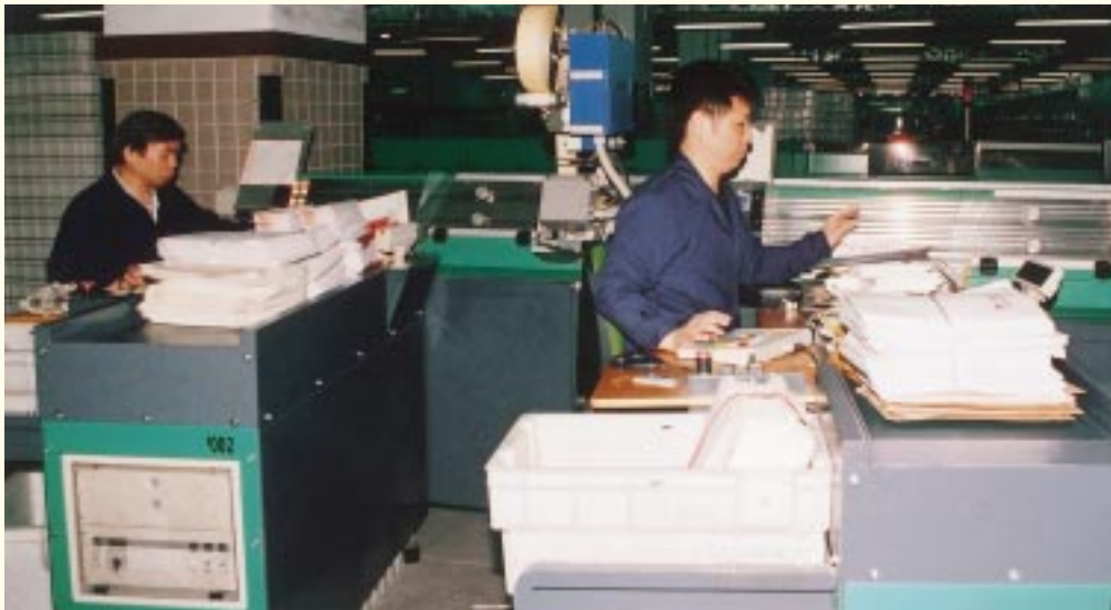
扁平型函件分揀機 Flat sorting machine
